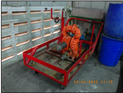
รูปที่ 3.24 Diaphragm Pump
