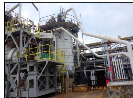
รูปที่ 3.101 Jacket ห่อหุ้มถัง R2
